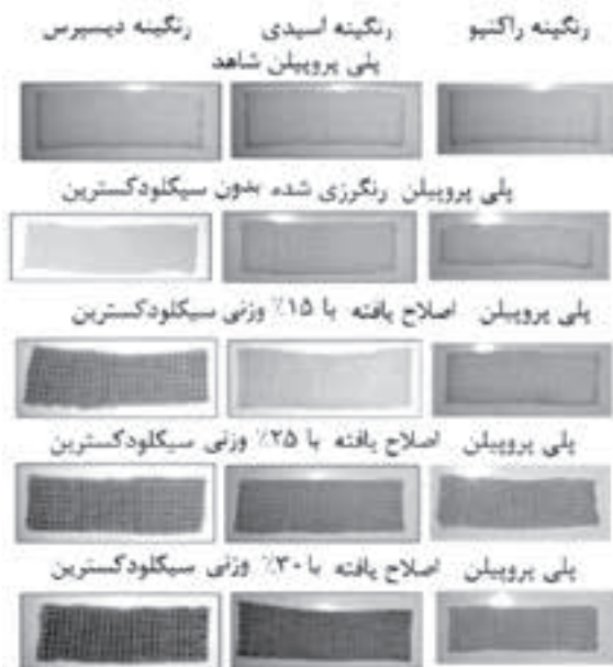
شکل ۶. الف) برهم کنش‌های مختلف میان رنگینه راکتیو Yellow Lanazol 4G و الیاف پلی پروپیلن اصلاح یافته با بتا-سیکلودکسترین و ب) نمونه پارچه‌های پلی پروپیلن شاهد و پلی پروپیلن (اصلاح یافته با درصد‌های مختلف سیکلودکسترین) رنگرزی شده با سه رنگینه اسیدی، دیسپرس و راکتیو [۴]
