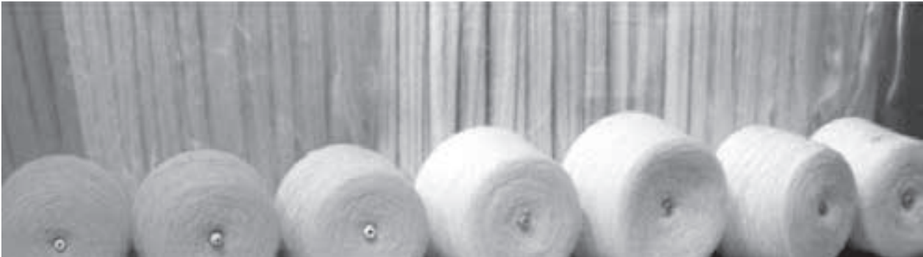
شکل ۹. الیاف پلی پروپیلن رنگرزی شده با رنگزای دیسپرس
